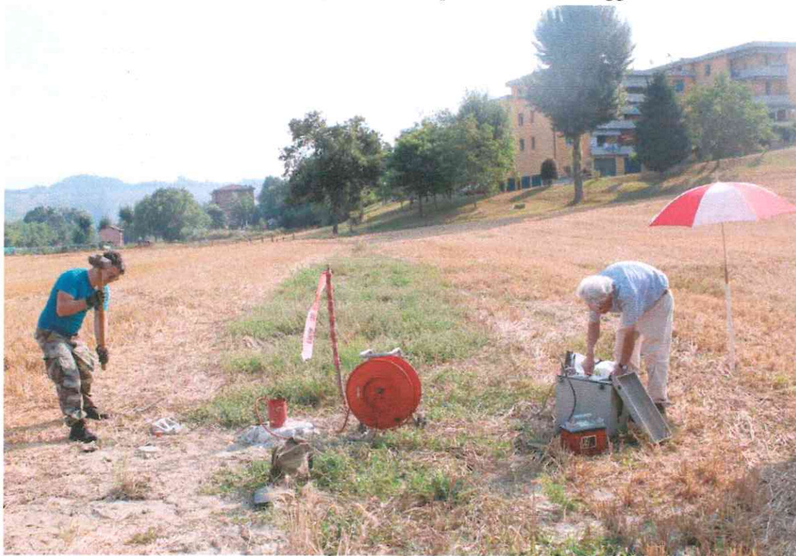
Figura 10. Esecuzione della prova down hole.
