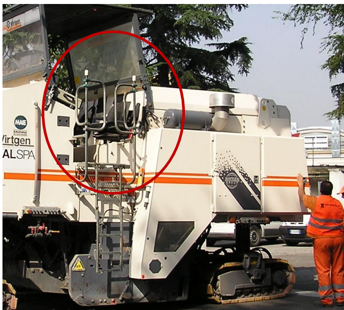
fig. 07 - Protezione del posto di guida – cancelletto tenuto chiuso all'avanzare dei lavori
