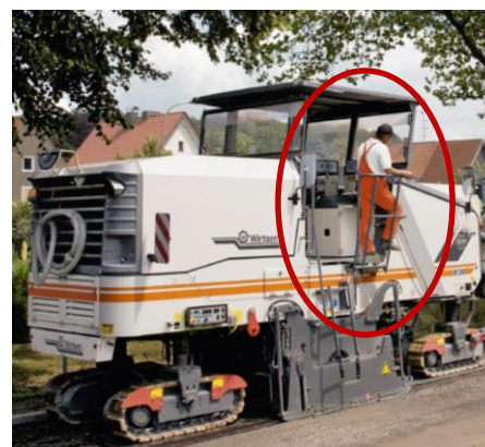
Fig. 06 - Protezione del posto di guida scarificatrice
