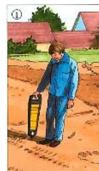
fig. 04 – uso rilevatore sottoservizi
