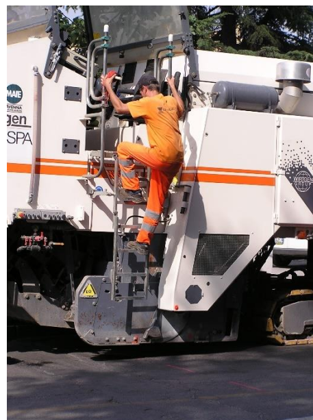
fig. 08 - cancelletto aperto per accesso al posto guida
