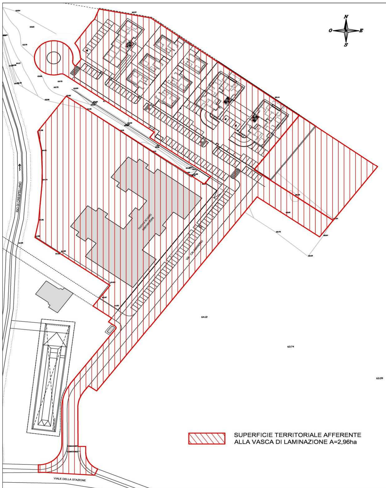
Figura 2 – Schema planimetrico superficie territoriale afferente alla vasca di laminazione
