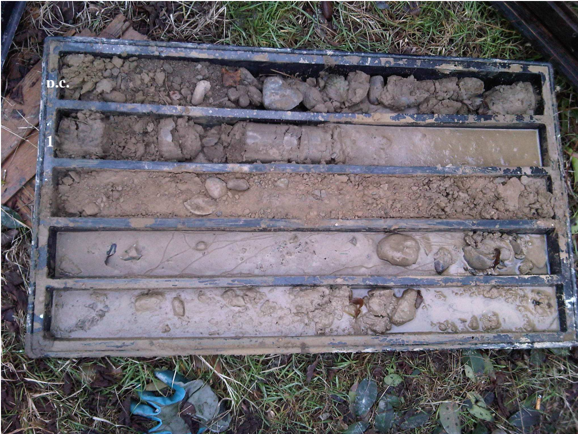
Foto 5 – Sondaggio S1pz/2011 –Sito Via Rio Verde: Cassetta dei campioni di terreno (p.c. a -5,00 m) prelevati, a carotaggio continuo nell'anno 2011. In S1pz/2011 è stato installato un piezometro a tubo aperto.
