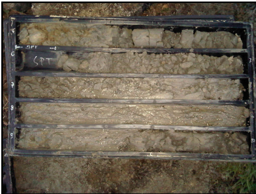
Foto 12 – Sondaggio S2pz/2011- Sito Via San Lorenzo. Cassetta dei campioni prelevati, a carotaggio continuo, da – 5,00 m. dal p.c. a -10,00 m.
