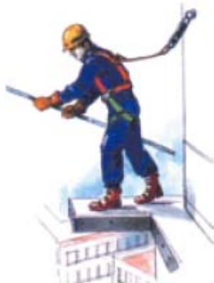
Posizione di lavoro con arrotolatore in posizione alta e bassa
