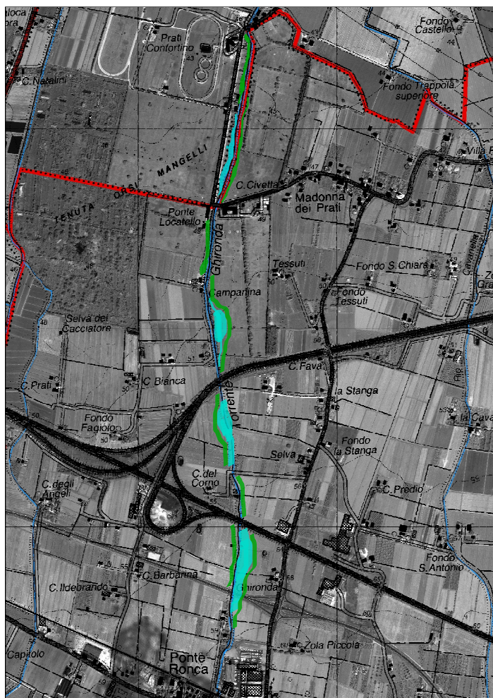
Figura 2-7 - Esempio schematico (non in scala) di possibile allargamento dell'alveo e realizzazione di impianti di vegetazione alternata in riva destra e sinistra-Scala 1:25.000
