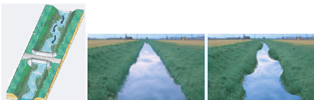
Figura 4.2 - Creazione di canale di corrente sinuoso con l'asportazione parziale della vegetazione erbacea (da PTA provincia di Bologna)
